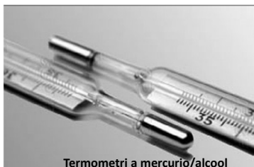
Termometri a mercurio/alcool
